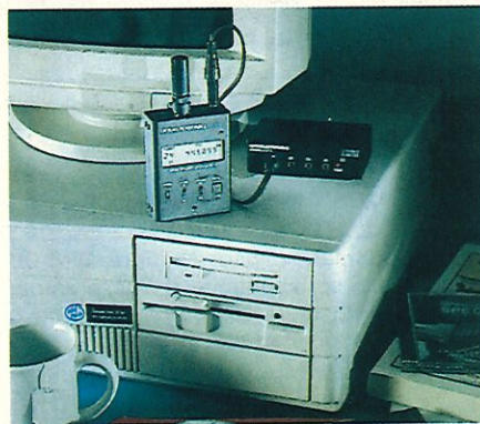
Possibilità di scaricare i dati su PC utilizzando Optolinx, interfaccia radio-PC (opzionale)
