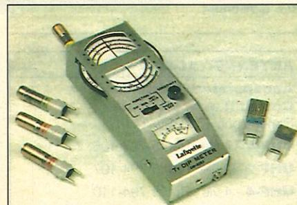
Strumento necessario per la messa a punto di antenne, la costruzione di apparati o dove vi siano dei circuiti accordati
