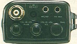
**Controlli Volume e Squelch separati per ricevitore e ricetrasmittitore**
