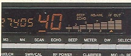
Particolare del display con visualizzazione del numero di canale, della frequenza e della scala SRF
